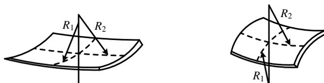
**Рисунок 4. Поверхности двойкой положительной (а), отрицательной (б) кривизны**
