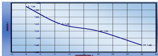
**Рисунок 15. График зависимости начальной скорости роспуска от температуры (при предлагаемой методике)**
